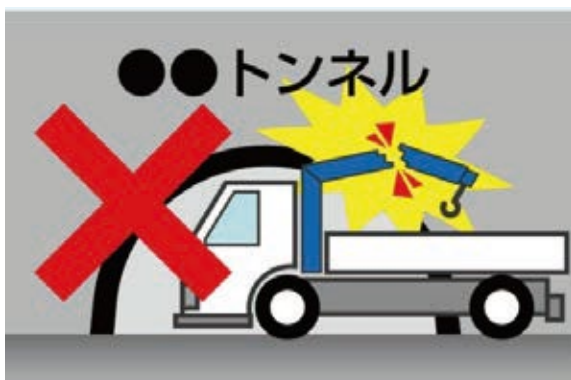
アームを閉じずに走行中し、トンネルと接触して破損した。
