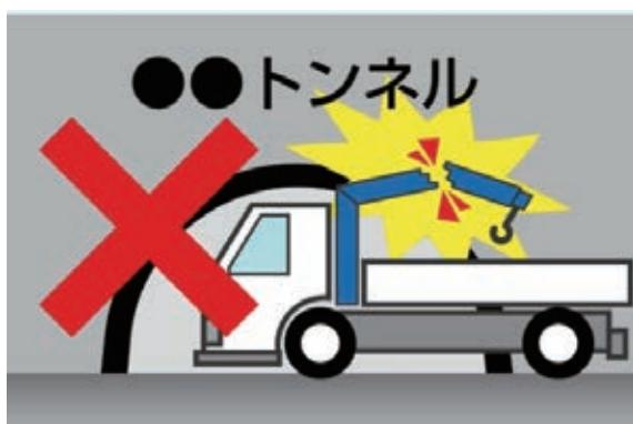
アームを閉じずに走行中にトンネルと接触し破損した。
