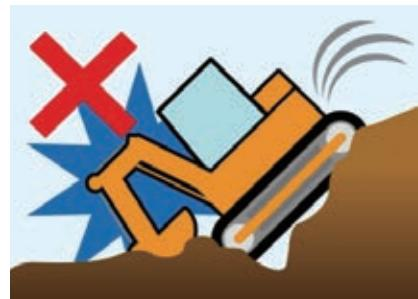
地震により地盤が崩れ、建機が転落、破損した。
